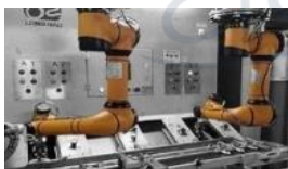
依靠机械定位实现固定模式抓取，无视觉识别
