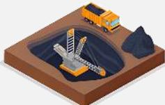
移除覆盖在煤层上的土壤和岩石，这个过程通常需要使用大型的开挖机和卡车
